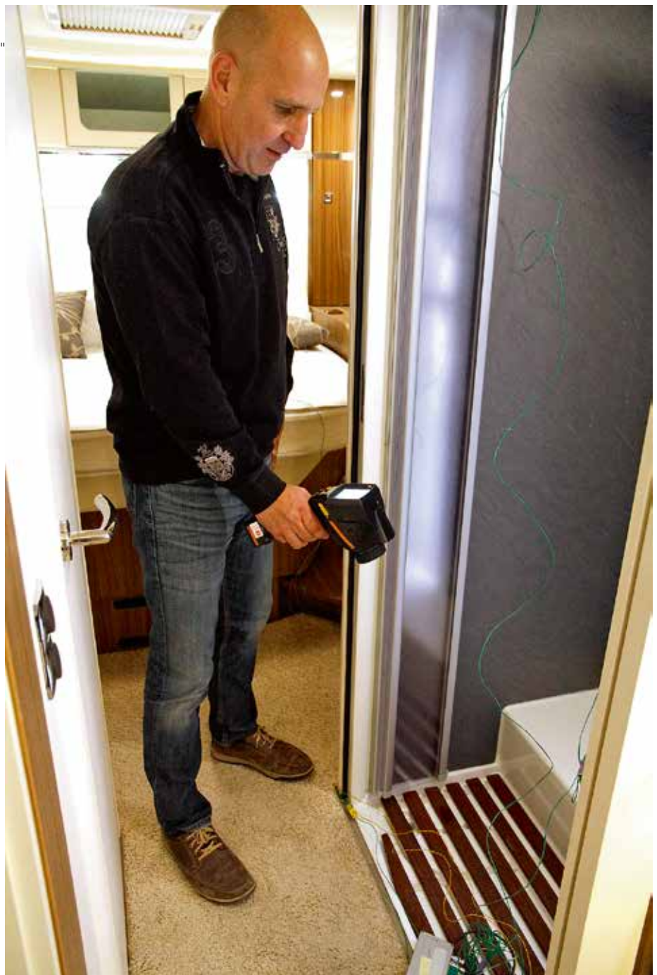
Andreas Holzhäusser fra Eura Mobil sjekker bobilen nøye med et termokamera. Det er 50 grader forskjell på temperaturen ute og inne, og svake punkter avsløres lett på det følsomme kameraet.
