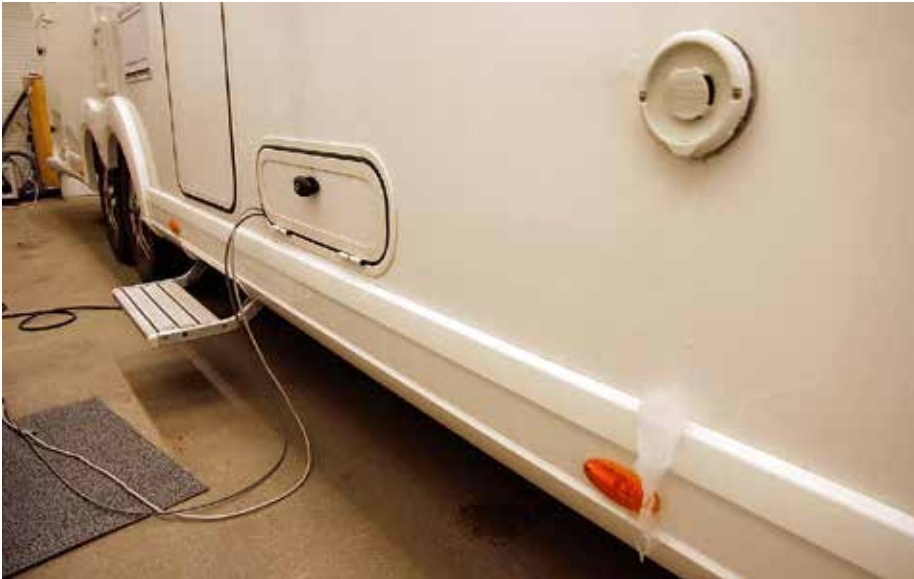
Bikkjekalt: Kondensen fra Aldevarmeren fryser til is i 25 minusgrader.
